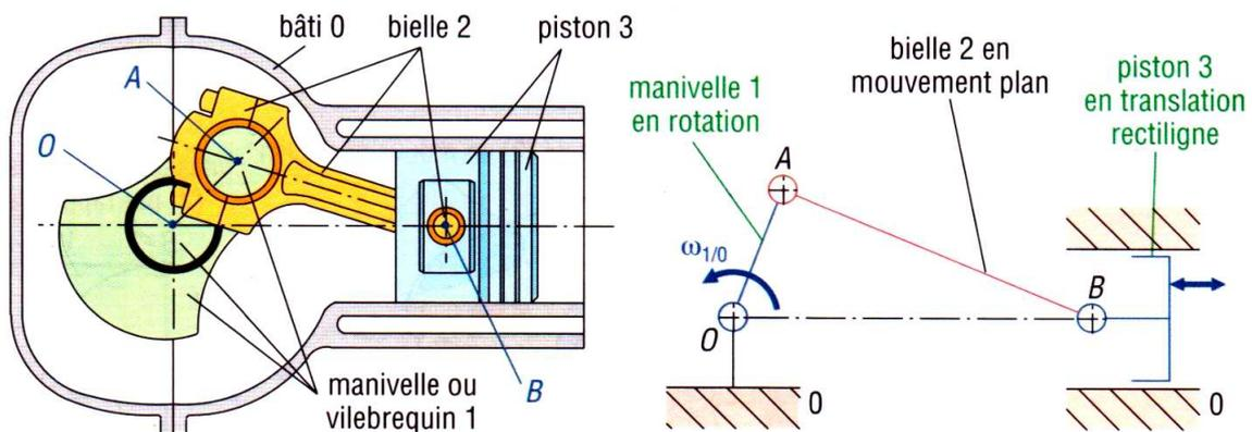
Les liaisons en O, A et B sont des pivots dont les axes sont perpendiculaires au plan de la figure.
