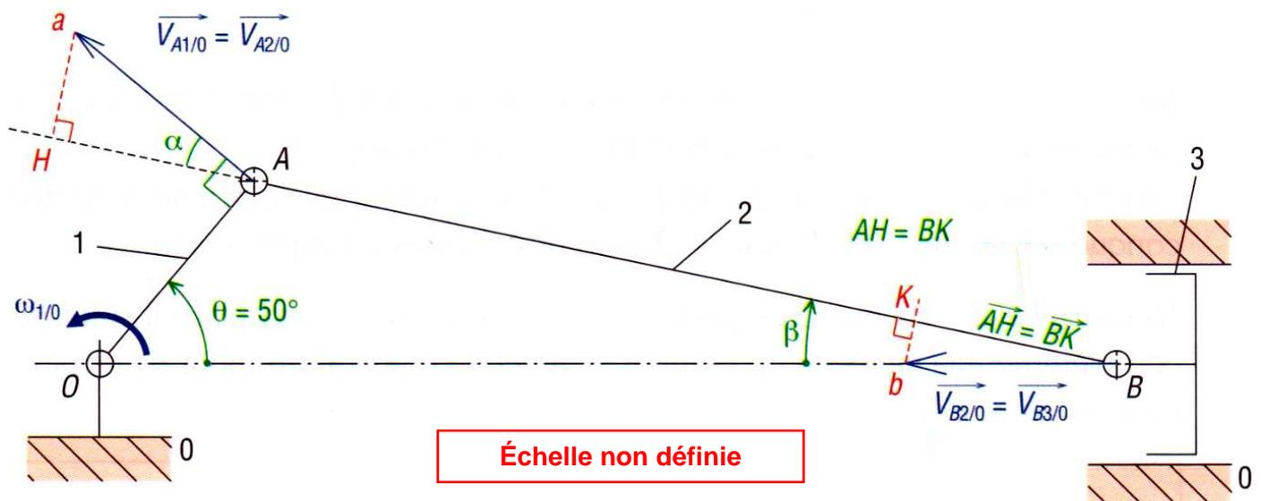
Mesure de  $V_B$  à l'échelle choisie :  $V_B = 3,15 \text{ m/s}$ .
