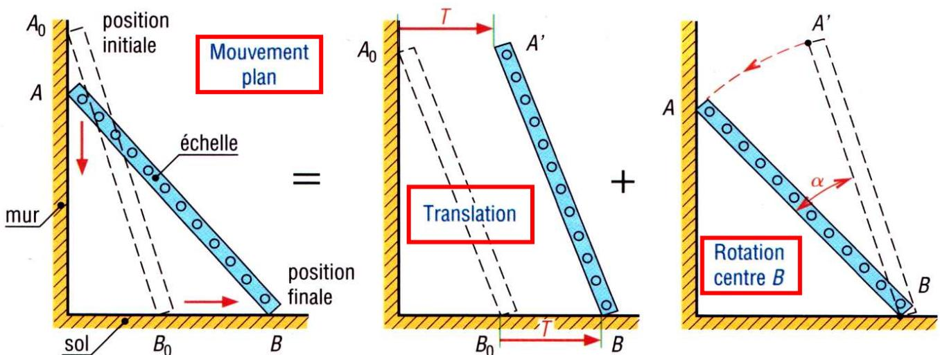
L'échelle décrit **un mouvement plan** par rapport à l'ensemble (sol + mur).
