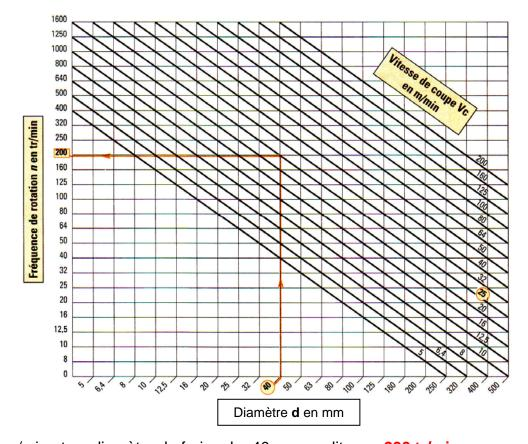
Avec Vc = 25 m/min et un diamètre de fraise d = 40 mm, on lit : n = 200 tr/min.
