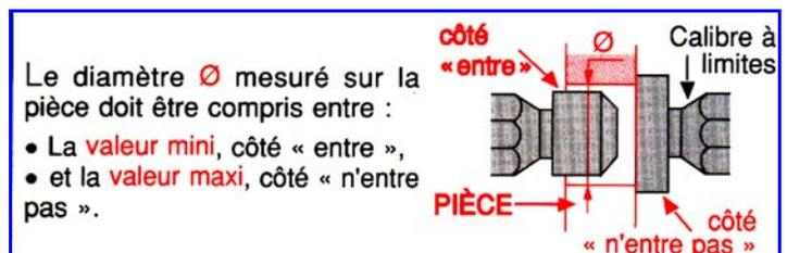
Mesurage et contrôle peuvent être réalisés simultanément.
